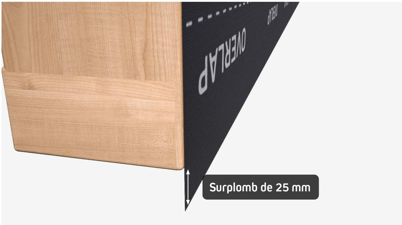
Veillez à ce que les poutres les plus basses du mur soient protégées, en surplombant la membrane d'au moins 25 mm.
