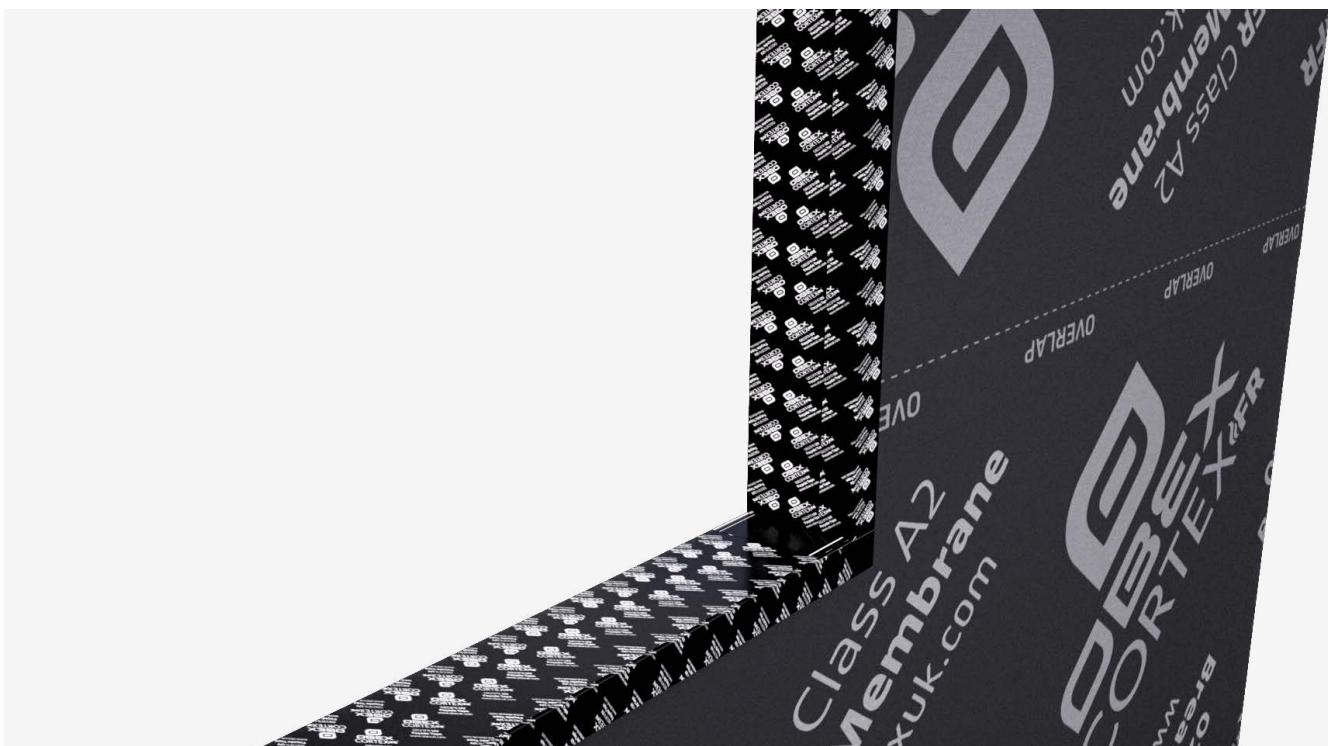
Scellez les bords de la Membrane pare-pluie avec du ruban adhésif UV pour façades. Scellez soigneusement tous les coins de l'embrasure. Commencez par appliquer le ruban directement sur la membrane dans chaque coin. Veillez à ce que le ruban soit fermement pressé en place, en recouvrant complètement la membrane dans ces zones. Une fois les coins fixés, continuez en étirant le ruban autour de l'avant et de l'arrière de l'ossature.
